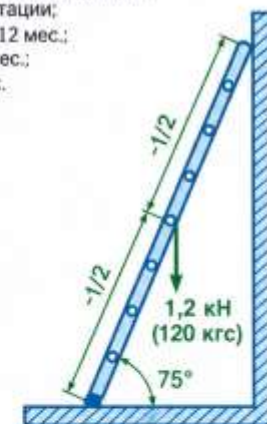
Рис. 5.5. Схема испытания приставной лестницы
