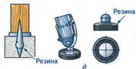
Рис. 5.3. Стремянки: а – деревянные; б – металлическая; в – трап для спуска в котлован; г – резиновый острый наконечник для установки лестниц и стремянок на земле; д – резиновые башмаки для установки лестниц и стремянок на асфальтовых, бетонных и других подобных полах
